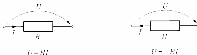
Abb. 6.11 Schaltzeichen für elektrische Widerstände, Bezugssinne und Ohmsches Gesetz
